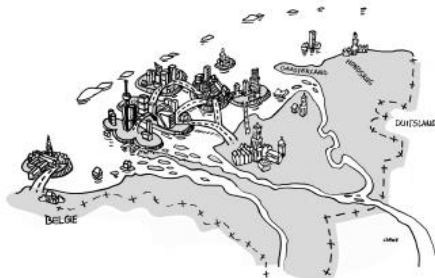
Figuur 11 Drie opties om te blijven wonen in de Nederlandse delta bij extreme zeespiegelstijging: 1) delta beschermen als een fort en de rivieren uit de delta pompen; 2) De polders beschermen met daartussen hele diepe rivieren; 3) De delta ophogen, als geheel of verschillende terpen die met elkaar verbonden zijn (©Beeldleveranciers-Carof).
