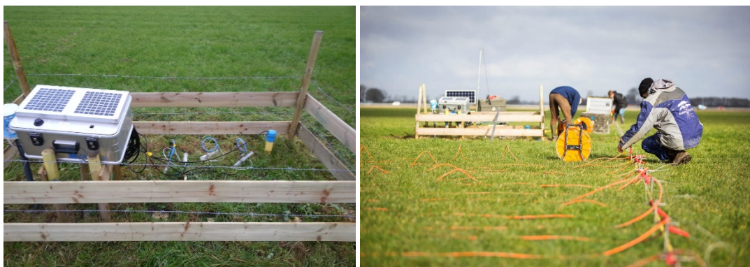
Figuur 42. Foto van een van de meetopstellingen in Herbaijum met resprobe, peilbuizen en bodemvochtsensoren (links) en het uitvoeren van een CVES in Herbaijum (rechts).
