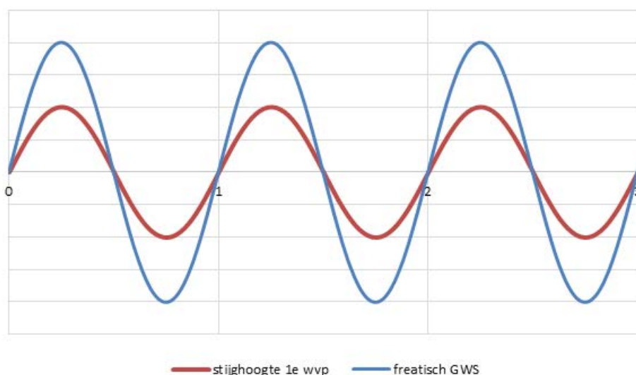
Figuur 12. Schematische fluctuatie van de freatische grondwaterstand en de stijghoogte in het eerste watervoerend pakket gedurende 3 jaren. Gedurende tijden van neerslagoverschot (blauw hoger dan rood) is er overdruk die resulteert in een neerwaartse druk (blauwe pijl). In droge tijden is er een overdruk vanuit het 1ste watervoerend pakket (rood hoger dan blauw) en is er daarom sprake van opwaartse druk (rode pijl).
