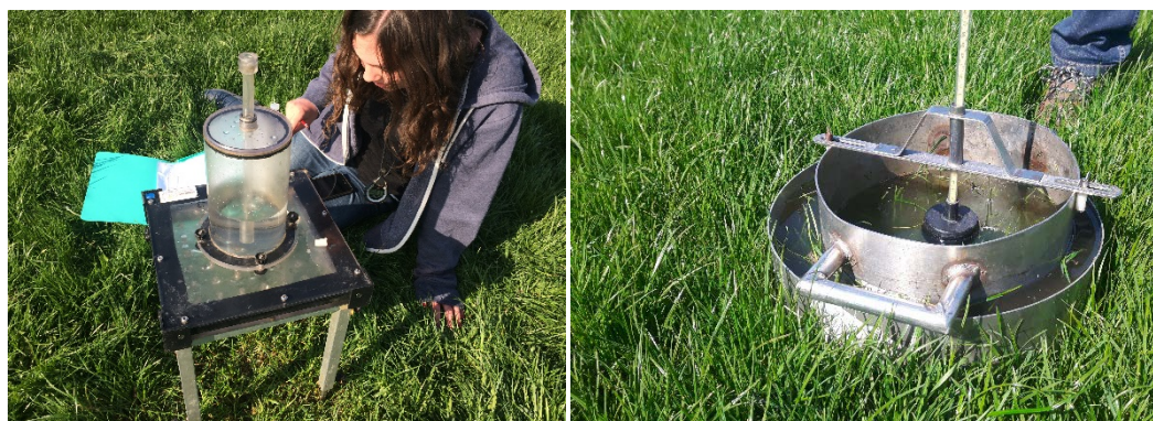
Figuur 65. Regensimulator voor het meten van oppervlakkige afvoer (links) en dubbele ring infiltrometer voor het meten van de infiltratiecapaciteit (rechts).
