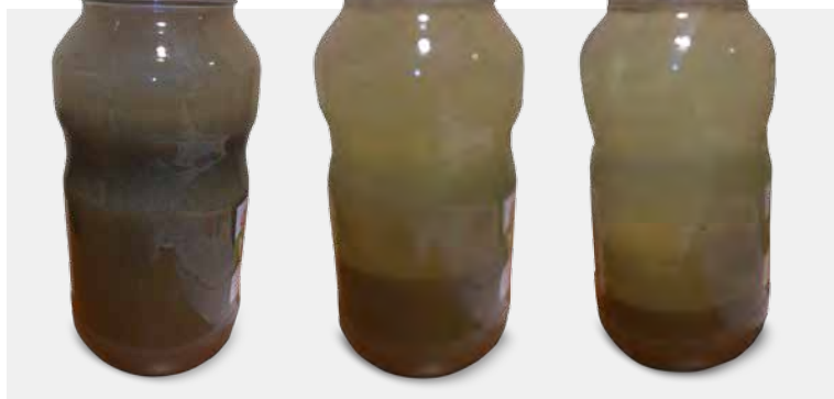
Links zoals het drainwater met klei er uitziet direct na opvangen, geheel rechts nadat de klei is neergeslagen.
