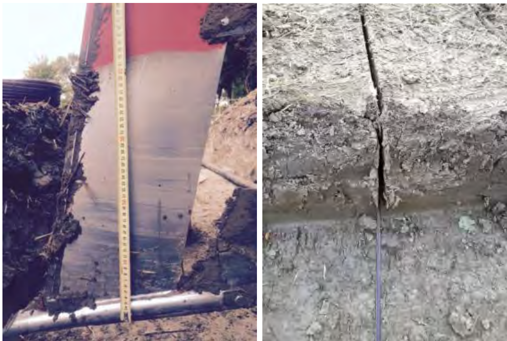
Figuur 6-5: Gebruikmakend van een voor aanleg van druppelirrigatieslangen gemodificeerde moldrain (links) zijn de drupslangen op diepte aangelegd (rechts) zonder schade aan de bodem in het perceel.
