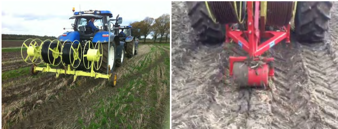
Figuur 6-4: Aanleg van drip irrigatie met de conventionele apparatuur in oktober 2013 (links) en met de nieuw ontwikkelde methode in oktober 2015 (rechts).
