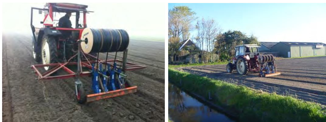
Figuur 6-1: Aanleg van drie druppelslangen in een bed na het planten van krokus in de zandgrond van het perceel in Breezand.
