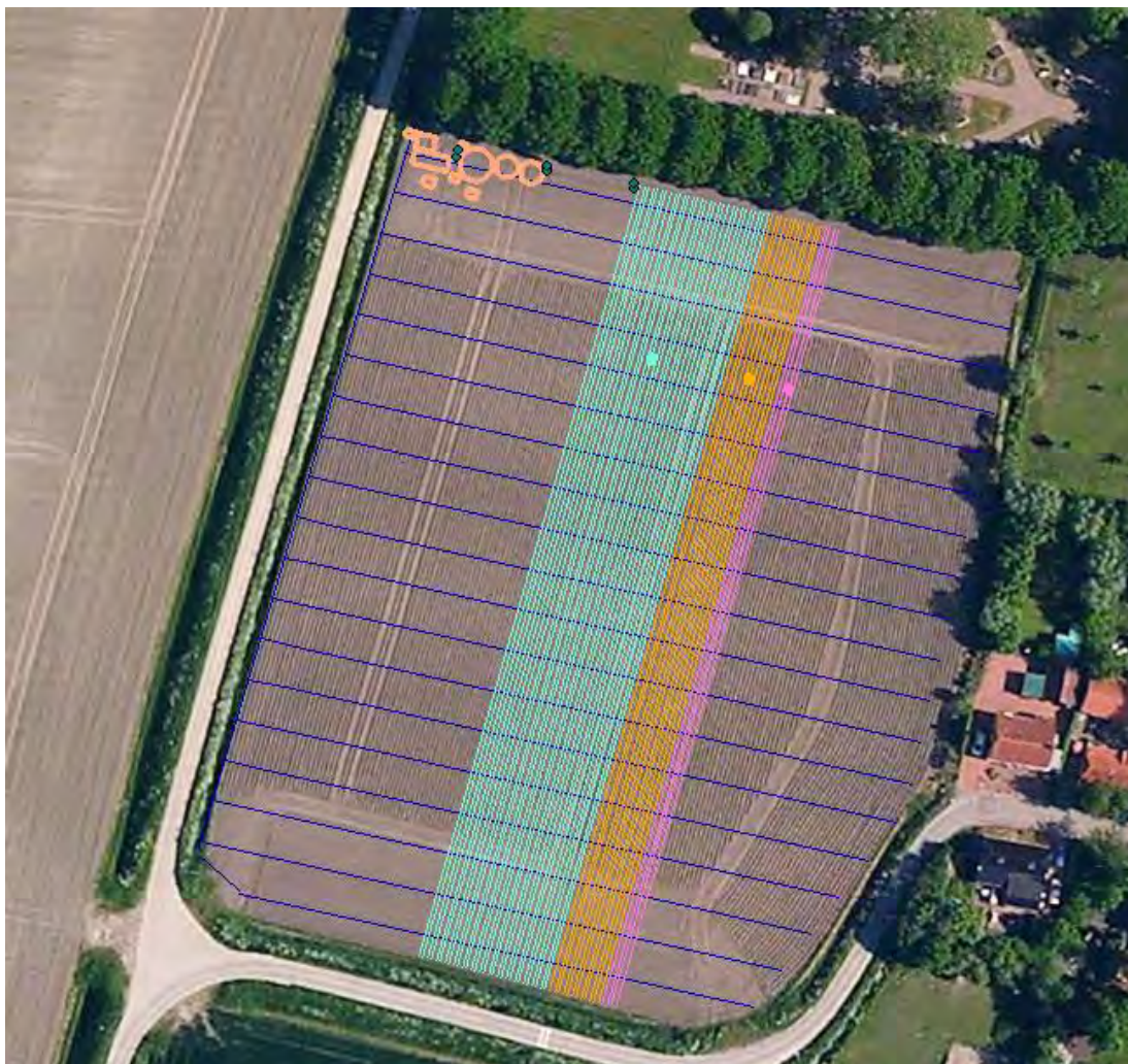
Figuur 3-3. Overzicht van het systeem in Borgsweer Groningen). De verschillende druppelirrigatieregimes voor 2015 zijn aangegeven in blauw (1 X / dag drip) en oranje (1 X / 2 dagen drip), terwijl het referentievelden roze is. De stippen in elk veld markeren de meetlocaties in de verschillende druppel regimes. Peilbuis locaties voor grondwaterstandsmetingen en infiltratie/extractie zijn in groen, terwijl het ondergrondse opslagsysteem in licht oranje is weergegeven. Satellietfoto achtergrond is verkregen van Microsoft Virtual Earth.
