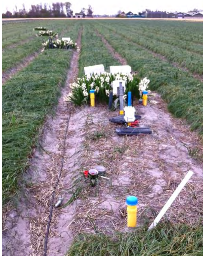
Figuur 3-5. Foto van de experimentele proefvakken in Breezand, waarin de grondwaterstand, bodemvochtigheid en bodem- en waterchemie gemeten werd. In het proefvak waren hyacinthen geplant, en op de omliggende bedden stond krokus (Foto Mirjam van Maanen).
