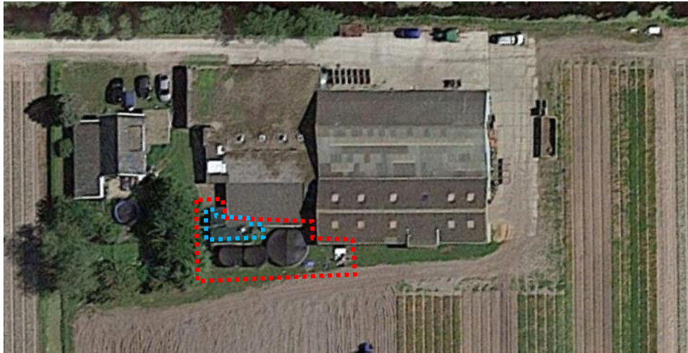
Figuur 67: Een luchtfoto van het huidige spaarwatersysteem, waarbij met rode stippellijnen het ruimtegebruik is weergegeven van de pilot opstelling. Met blauwe stippellijn is het ruimtegebruik weergegeven van het nieuwe doorontwikkelde systeem, dat in het AGRIMAR-onderzoek wordt toegepast (vanaf 2019).
