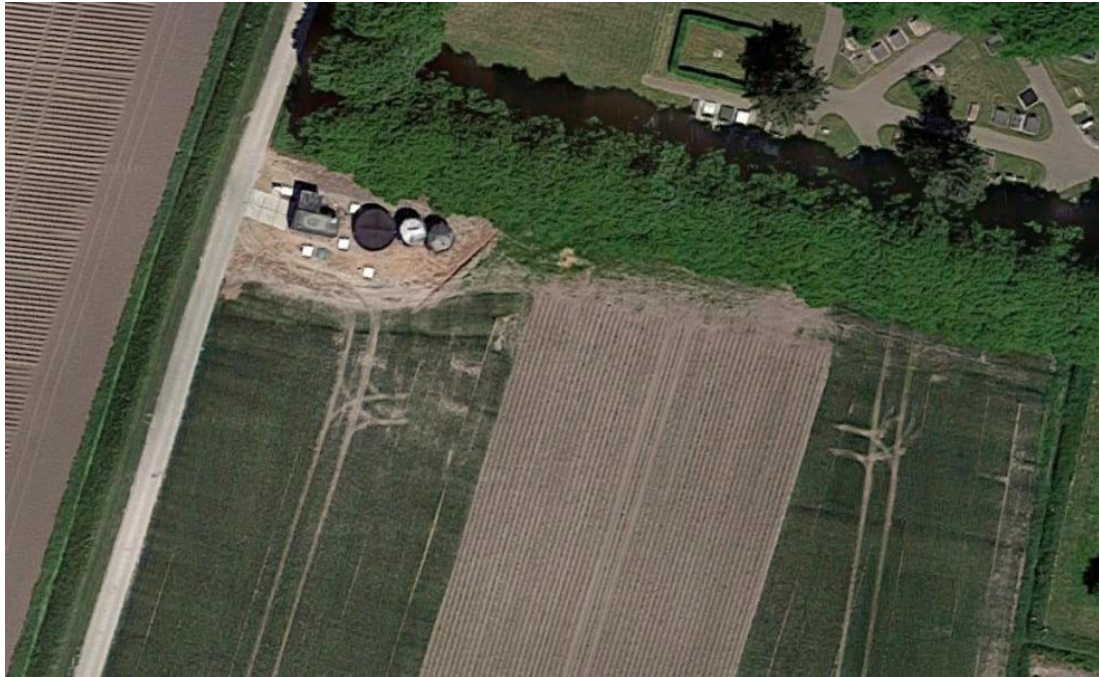
Figuur 10: Bovenaanzicht van het systeem voor ondergrondse opslag te Borgsweer, met van links naar rechts de container met apparatuur en leidingwerk, het zandfilter, de dagvoorraad en de buffertank.
